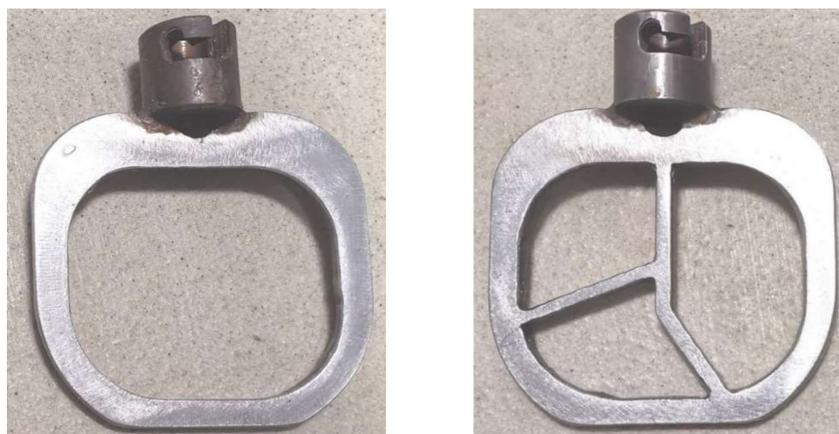
Figure 1 - Forme des pales d'homogénéisation (forme O et forme Y) permettant de respecter les tolérances du référentiel des réceptions interprofessionnel (source : ARTB)
